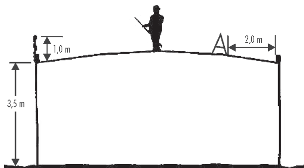
2 pav.: Stogo šlaitas, mažesnis nei 15^\circ
